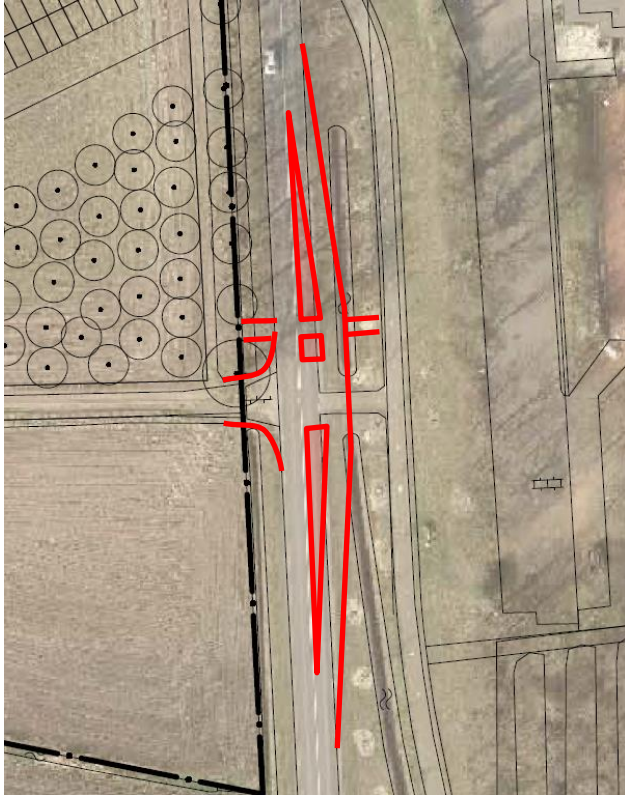
Afbeelding 4: Principeoplossing met middengeleider en fietsoversteek in huidige situatie
